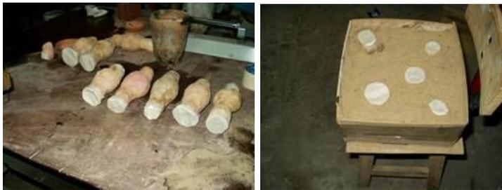
10. En la fragua, con crisol refractario, primero fundimos aluminio (a 600° C), vertimos en los moldes y luego fundimos bronce (a 1200° C) y vertimos.
