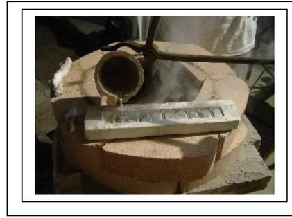
El horno se puede perfeccionar poniendo cemento refractario entre los ladrillos, para evitar las pérdidas, pudiendo subir así a los  $1200^{\circ}\text{C}$  para fundir bronce ( $1150^{\circ}$  a  $1200^{\circ}\text{C}$ ). También se considera arreglar la manta para que asiente mejor y rellenar los huecos poniéndoles silicato de sodio, a fin de que no pierda calor. No es un horno para conservar, pero por eso tampoco debería bajar a mucha velocidad la temperatura.
