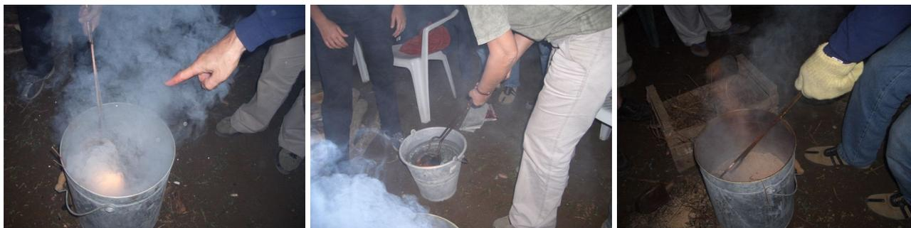
Se van distribuyendo las piezas alrededor de la fogata a unos 80 cm de distancia, disponiéndolas sobre ladrillos para que no absorban humedad del terreno (las piezas vienen con distintos grados de secado).
