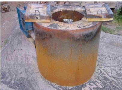
La fabricación de un horno para fundir bronce se hizo en base a ladrillo refractario (con una entrada lateral para el quemador de gas). Se cubrió el exterior con manta cerámica y acero.
