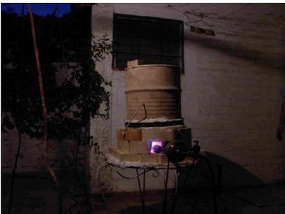
Horno para fundir hierro a crisol abierto. Coque y aire comprimido.
