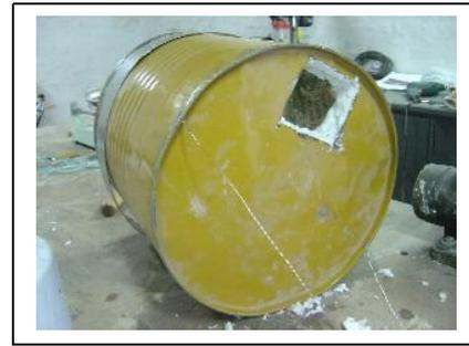
A mitad de la altura del tonel se hace una perforación en la chapa y en la manta para colocar el pirómetro
