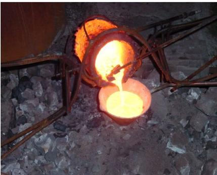
Se trabajó con peltre, aluminio, alpaca, bronce y hierro. Para el peltre se usan moldes de yeso directamente, dado el bajo punto de fusión. Es importante asegurarse que el molde esté
