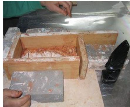
Si el original tiene recovecos hay que rellenarlos para que no tengamos dificultades en la extracción del positivo. Aristas y perfiles tampoco deberían generar concavidades en el molde, aunque todos esos detalles se pueden tallar y perfilar a punzón una vez que la pieza haya secado y se extraiga del negativo.
