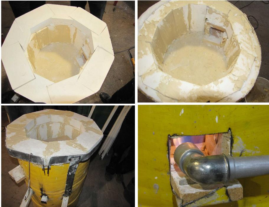
**La entrada del fuego** se hizo totalmente con ladrillos, orientada en diagonal hacia la izquierda, para que el fuego gire en el interior del horno.
