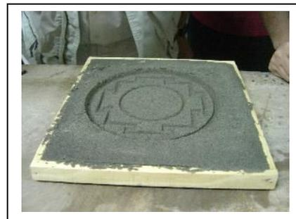
A continuación se mete el molde con el marco ya relleno y apoyado en el cartón en la cámara abierta (a su vez apoyada para que no se mueva).
