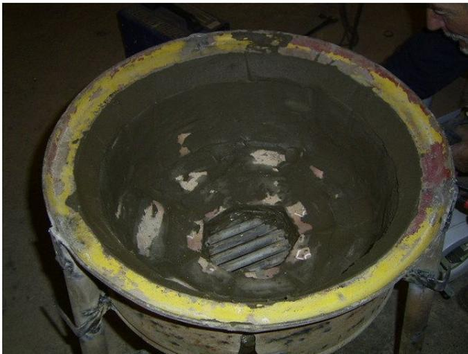
Bastones de ladrillo refractario pegado con cemento especial al interior de la fragua. Nótese las barras de acero en el centro, para permitir la entrada de aire e impedir que las cenizas obstruyan el cenicero.
