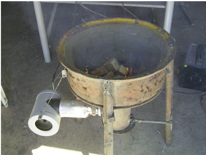
Nuestra Fragua terminada. A la izquierda el ventilador (hecho con un extractor de cocina). Se observa el mecanismo de control de flujo de aire, que se obtiene abriendo y cerrando la tapa inferior del cenicero. Se coloca carbón coque al interior con algunas ramitas que se encienden. El aire del ventilador aviva el fuego, que puede alcanzar más de 1200° C.
