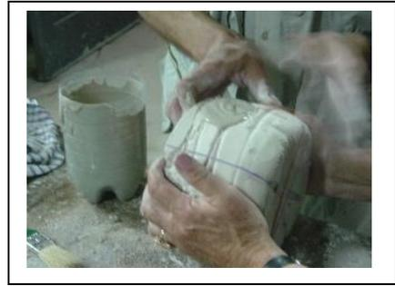
Se la deja fraguar de una a dos horas aproximadamente (dependiendo de la temperatura ambiente y de lo seco que esté el yeso) y luego se vuelca el resto, quedando adherido al yeso una película de  $\frac{1}{2}$  cm. de espesor.
