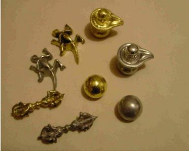
Se usó bronce de distintas calidades, sin saber su exacta aleación. Fusiona de 1200° a 1280° grados centígrados. Las primeras fusiones se realizaron en horno con aislamiento de manta cerámica y un quemador de gas butano. Se utilizó un crisol de carburo de silicio con una capacidad aproximada a los 15 kg. Luego se siguió fundiendo en el horno de carbón de coque y en la fragua.
