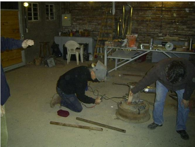
Soldadura de las patas a la rueda de camión.
