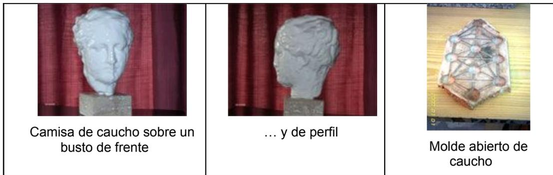
Es el material idóneo para hacer moldes en negativo, y al no tener que ser destruido para extraer la pieza, permite la fabricación de figuras en serie. También admite trabajos con una resolución muy detallada, copiando hasta el más mínimo cambio en la superficie de la pieza. Es decir, es capaz de dejar marcas en las copias con detalles de algo tan fino como un pelo o un grano de arena.
