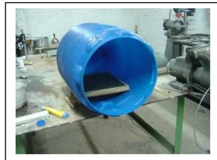
Se procede a tapar la cámara asegurándola con la abrazadera. Por el pico de inflado se le enrosca la manguera de gas y se le da hasta que se infle la tapa (abrir y cerrar el gas).
