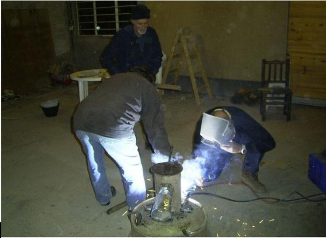
Soldadura del cenicero, que es el tubo inferior por donde entra el aire, y permite que las cenizas no obstruyan los orificios de entrada.
