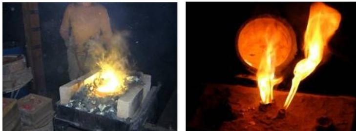
11. Se espera un poco y se sumergen completamente en un tacho con agua hasta lograr el enfriamiento. Con un martillo se rompe la cáscara de cerámica.
