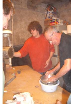
Se mezclan adecuadamente los dos componentes y luego ¡un poco más! Terminar de amasar golpeando los bloques para sacar el aire.
