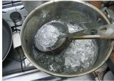
Con una cocina a gas se puede alcanzar suficientes grados en los metales de baja temperatura de fusión, pero hemos tenido que utilizar un soplete a gas, de los que se usan en fontanería, para poder llegar a la temperatura necesaria para fundir antimonio. Una vez licuados los metales, se agita o remueve la mezcla para que quede uniforme y se quitan las impurezas que flotan en la superficie. En ese momento la aleación ya está preparada para verter en el molde.
